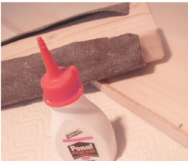
Nasenleiste an den Flügel kleben und verschleifen
