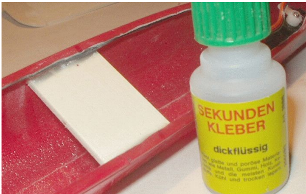
Das Flügelhaltebrett wird im Abstand von 75mm zum Anfang der Flügelauflage in den Rumpf geklebt
