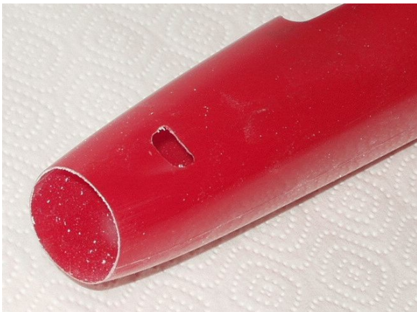
Lüftungslöcher in der Rumpfnase auffräsen
