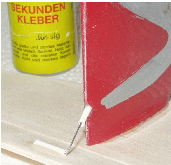
Als Ruderhorn dient ein Stück vom Zug. Der Draht wird abgewinkelt und reingeschoben
