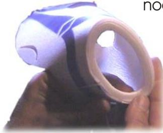
**13** Als nächstes wird der Ringspant von hinten ohne Klebstoff in die Motorhaube eingeführt. Durch Drehen kann er noch sauber ausgerichtet werden. Danach wird er mit Klebstoff eingestrichen und der eigentliche Motorspant wird von vorne angedrückt. Wenn alles getrocknet ist muss mit Schmirgelpapier noch eine schöne Rundung geschaffen werden.
